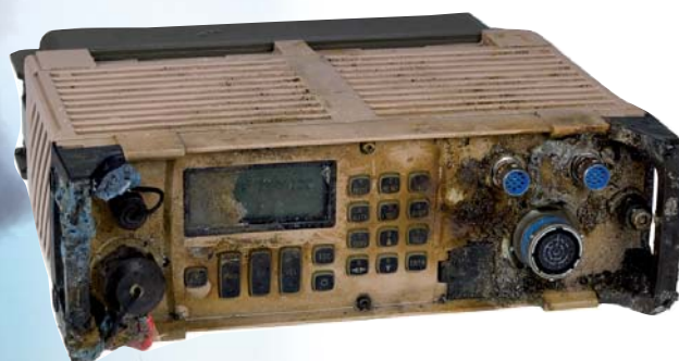
Radiostacja RRC9210 wyjęta ze zgliszcz firmowego stoiska. Mimo stopienia się części wykonanych z tworzywa oraz uszkodzenia wyświetlacza urządzenie było sprawne i przy jego pomocy można było nawiązać łączność.
