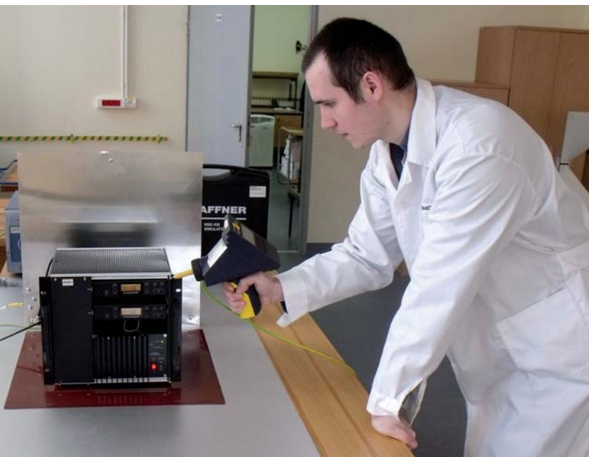
Badanie odporności na wyładowania elektrostatyczne urządzenia retransmisyjnego UR3801
