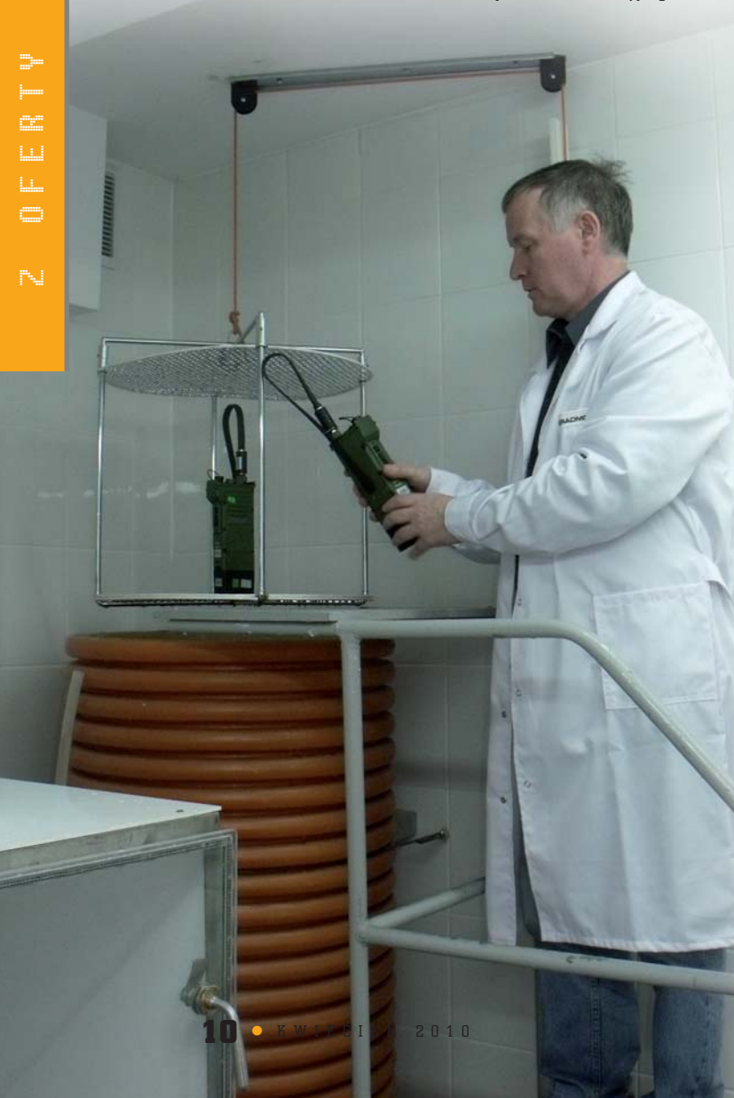
Badanie odporności na wyładowania elektrostatyczne urządzenia retransmisyjnego UR3801
