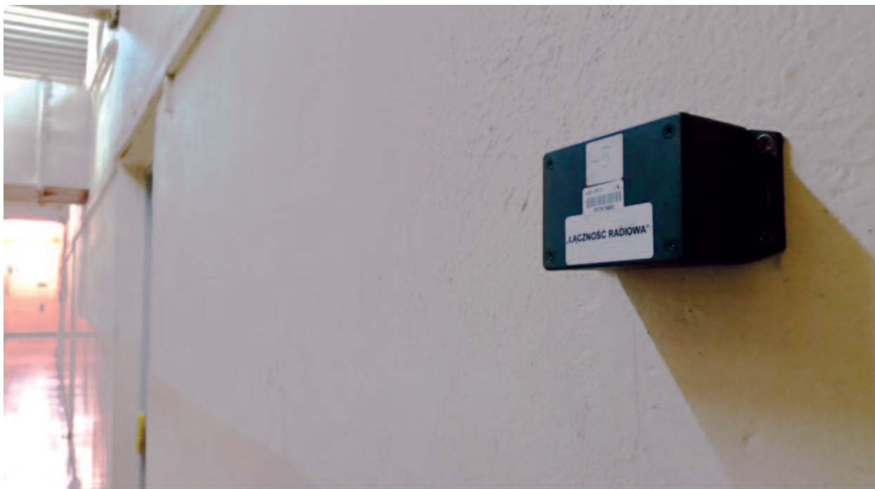
Znacznik lokalizacji zainstalowany w jednym z budynków elektrowni
