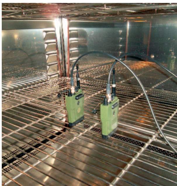
Radiostacja R35010 w komorze temperaturowej...
