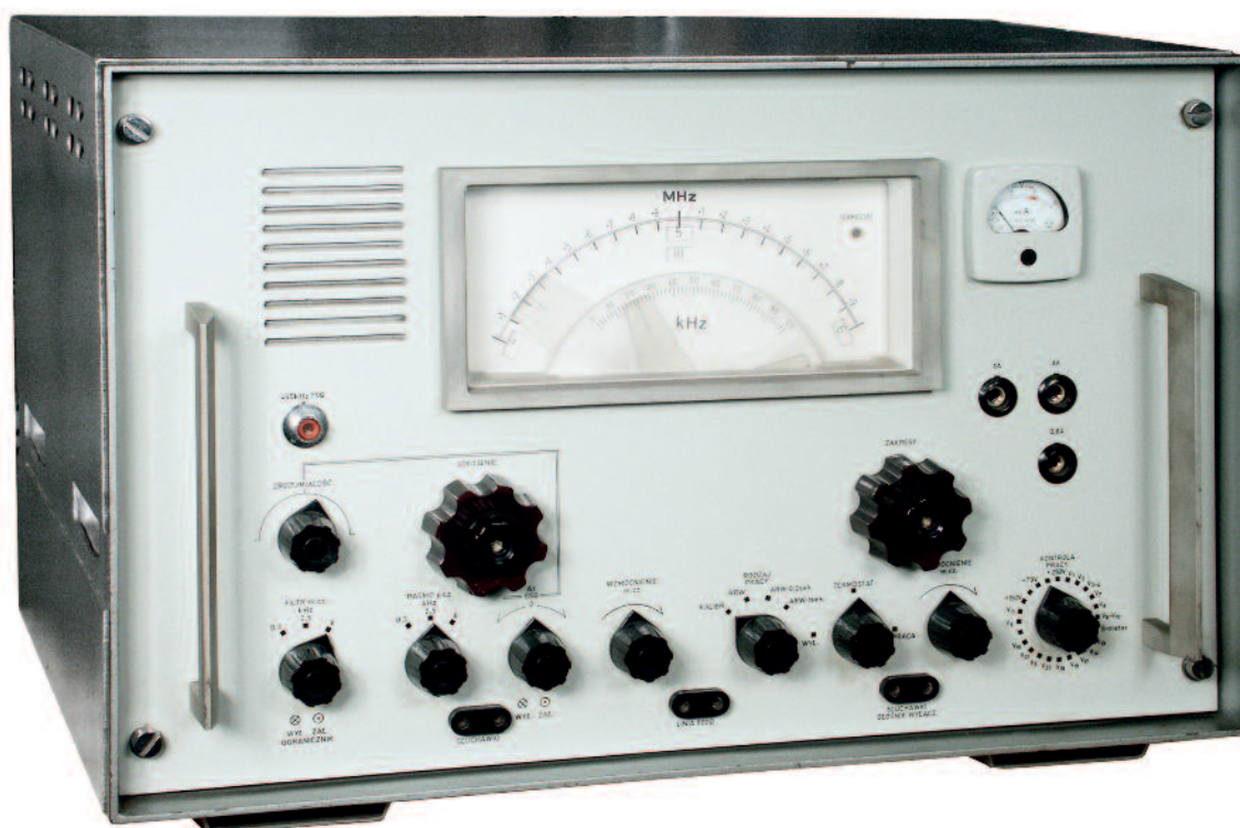
Odbiornik komunikacyjny OMNK-112 (1967-1973) – pracował m.in. na transatlantyku MS BATORY, aż do momentu zakończenia jego eksploatacji
