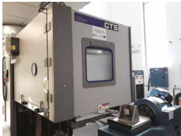
Komora klimatyczna współpracująca ze wstrząsarką wibracyjną
