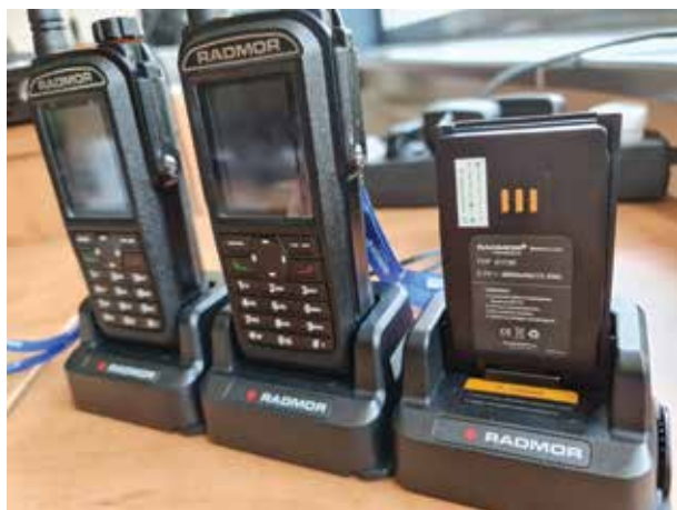
W urządzeniu ładującym można umieścić do ładowania cały radiotelefon lub sam akumulator
