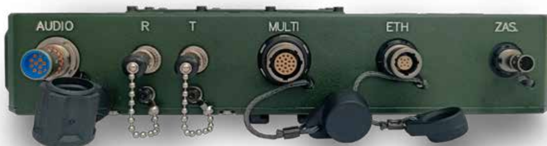
Widok komputera pokładowego od strony złączy
