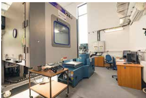
Wstrząsarka wibracyjna i współpracująca z nią komora klimatyczna
