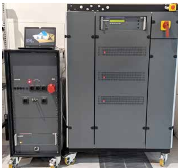
Netwave20.2 z wyposażeniem umożliwiającym pomiar emisji harmonicznych/Flicker'ów
