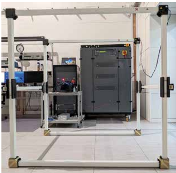
Wyposażenie umożliwiające przeprowadzenie badań odporności na pole magnetyczne większych obiektów za pomocą cewki Helmholtza.
