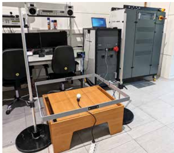
Badanie odporności na pole magnetyczne przy pomocy standardowej anteny 1x1m
