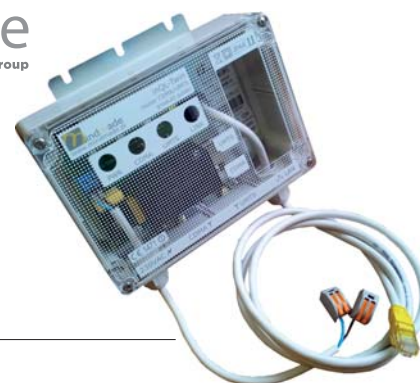
Profesjonalny router telemetryczny do zdalnego odczytu liczników energii (fot. MindMade)
