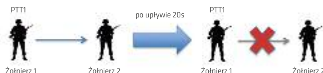
Rys.9 Realizacja usługi automatycznego zwolnienia kanału
