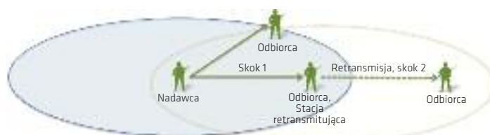
Rys.10 Automatyka retransmisja przez pojedyncze radio
