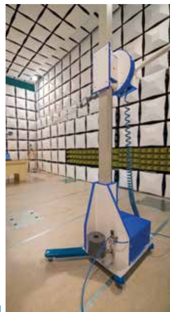
Stanowisko pomiarowe do badań emisji promieniowanej
