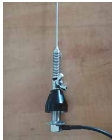
Fot. 3 Przewód antenowy ze złączem kątowym o wydłużonym gwincie
