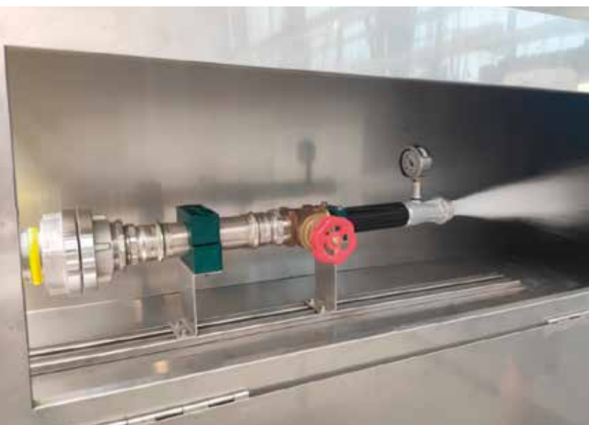
Armatka wodna do wykonywania badań strugoszczelności zg. z normą NO-06-A107
