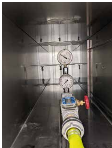
Widok podczas prób strugoszczelności - armatka do prób IPX5 oraz IPX6.
