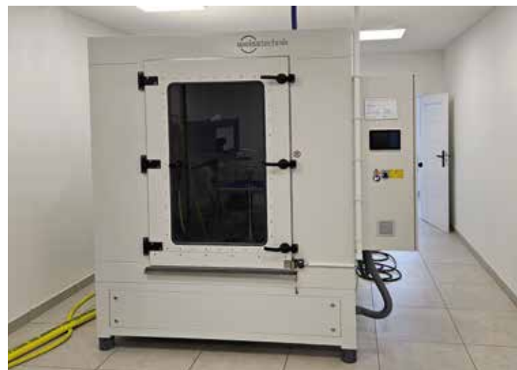
Komora do prób wodnych (widok od frontu)
