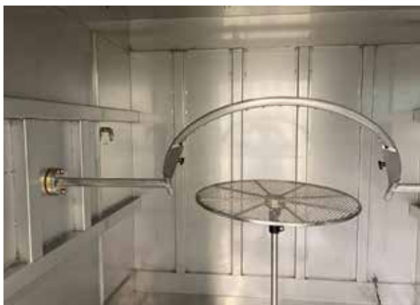
Pałak oraz obrotowy stolik do prób bryzgoszczelności
